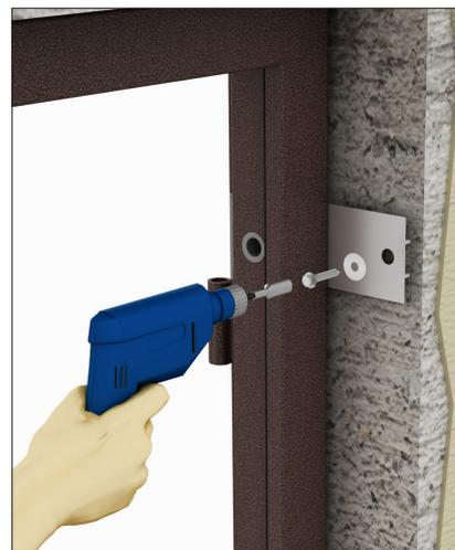
Просверлите 8 отверстий глубиной 100-150 мм. В просверленные отверстия установите анкерные болты/нагили и затяните головкой/ключом типа торекс.
