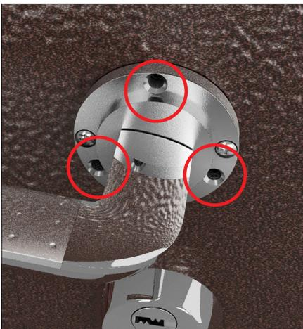
В оставшихся отверстиях на ручках просверлите отверстия сверлом диаметром 2-2,5 мм и закрутите саморезы которые идут в комплекте.
