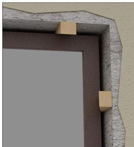
Зафиксируйте раму в проеме по уровню с помощью распорных клиньев устанавливая их между стеной и рамой с внутренней стороны двери
