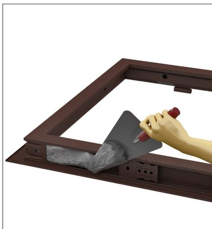
Заполните пустоты дверной коробки бетонным раствором по всему периметру рамы двери.
