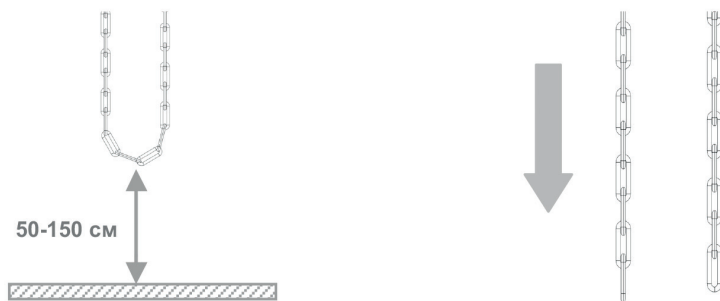
Рис. 2. Управление воротами с использованием ручного цепного редуктора
